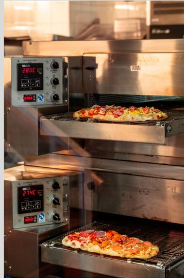
Далее пицца помещается в конвейерную печь. Процесс выпекания не требует контроля со стороны сотрудников пиццерии.
